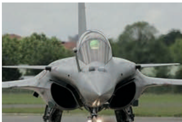
Rafale équipé d'un optronique secteur frontal permettant de suivre les cibles grâce à un capteur sensible aux ondes lumineuses visibles et infrarouges.
