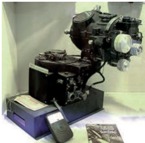
Visueur de bombardement Norden bombsight .
