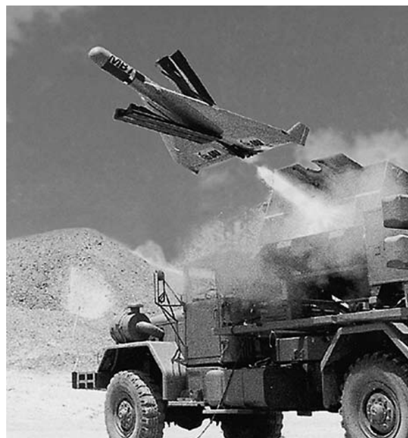
Le drone Harpy est une arme conçue pour détecter, attaquer et détruire les radars.
