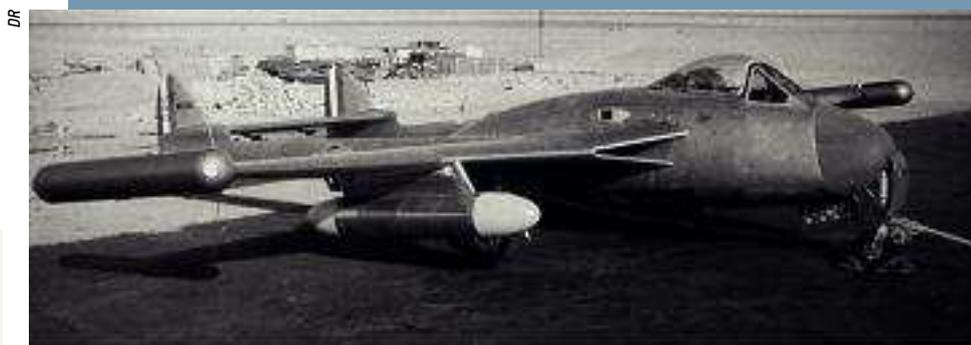
*Mistral téléguidé : Une dizaine de Mistral téléguidés ont été utilisés afin de servir de cibles radioguidées pour la mise au point des missiles air-air. Les missiles tirés n'étaient pas tous à charge explosive et les avions étaient dotés de bidons-caméras spéciaux fixés sous les ailes. D'autres bidons, fixés en bouts d'ailes, étaient équipés de dispositifs proximétriques associés à un jeu de caméras. Ces Mistral ont été les derniers avions de ce type maintenus en état de vol.*
