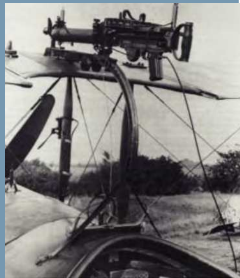
Mitrailleuse sur l'aile supérieure d'un biplan (câble de commande visible).
