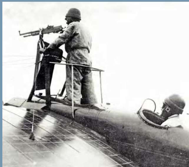
Installation "déraisonnable", sur un monoplan, pour tirer au-dessus de l'hélice.
