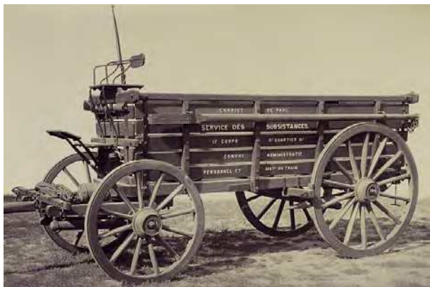
Chariot hippomobile avec essieu avant articulé sur "cheville ouvrière".
