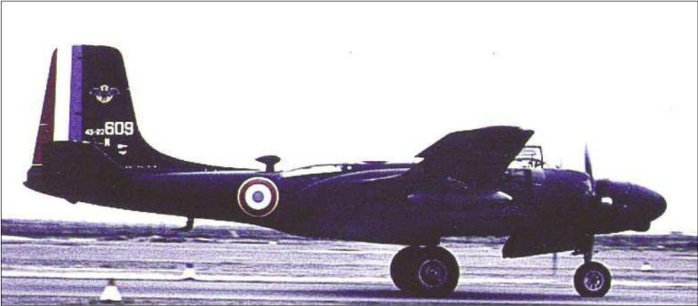
Sur la photo, on reconnaît bien le nez et le radome du NF11 qui s'est parfaitement adapté au maître-couple du B 26
