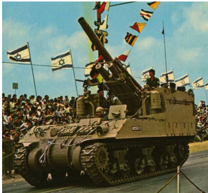
Fig. 7 Obusier de 155 sur châssis Sherman
