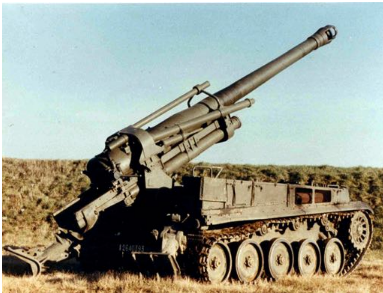
Fig. 19 Le canon automouvant de 155 F3 Am
