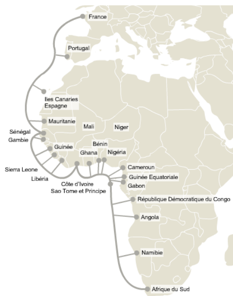
Câble sous-marin ACE - Source : ACE
