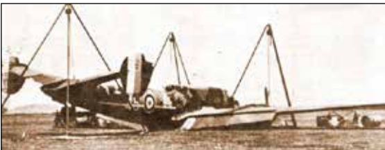
Sur un aérodrome de Syrie, un LeO-451 endommagé par un raid aérien britannique est en cours de réparation.
