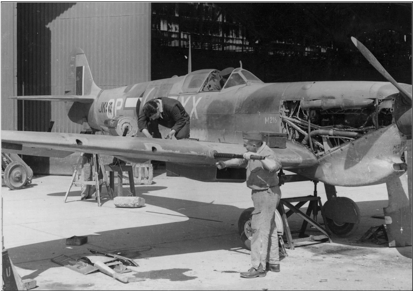
Deux mécaniciens effectuant l'entretien des mitrailleuses de voilure d'un Super Marine Spitfire à Maison Blanche, Algérie.
