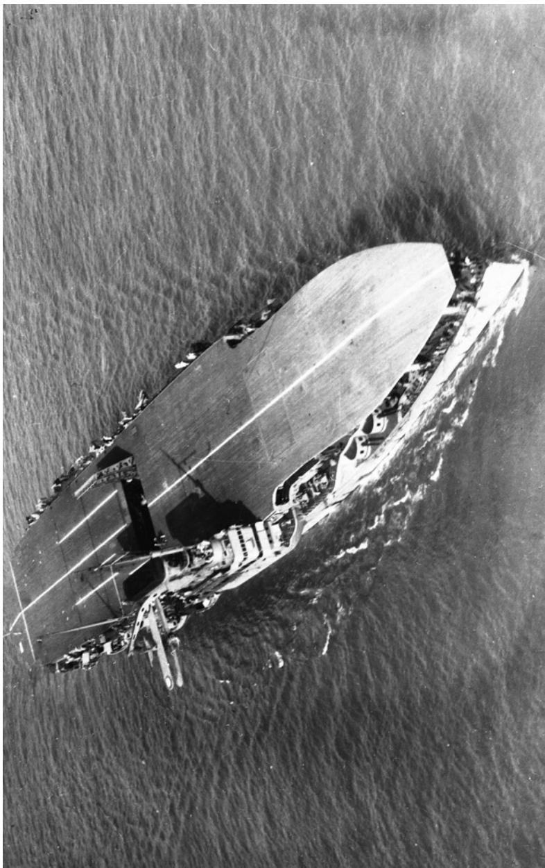
Le porte-avions Béarn emportant des avions Lévasseur PL4 , vers 1929. Construit à partir d'un cuirassé inachevé, le Béarn est le premier porte-avions français. Preuve toutefois que la Marine nationale, comme ses homologues, n'a pas encore pris la mesure de l'importance de la troisième dimension dans la guerre navale, ses performances s'avèrent vite insuffisantes pour qu'il soit vraiment apte à sa mission. Sa vitesse est en particulier insuffisante pour lui permettre de suivre les autres bâtiments de combat.
