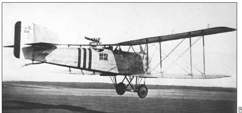
Le Breguet 14 , bombardier français pouvant porter 520 livres de bombes. Musée de l'Air.
