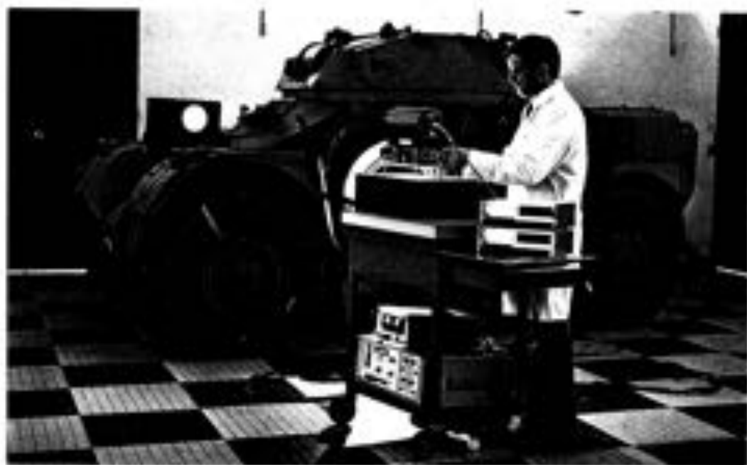
PREPARATION EN LABORATOIRE DE MESURES ACCELEROMETRIQUES ET VELOCIMETRIQUES SUR UN BLINDE LEGER, AVANT LE DEPART POUR LE TUNNEL DE SAUCLIERES.
