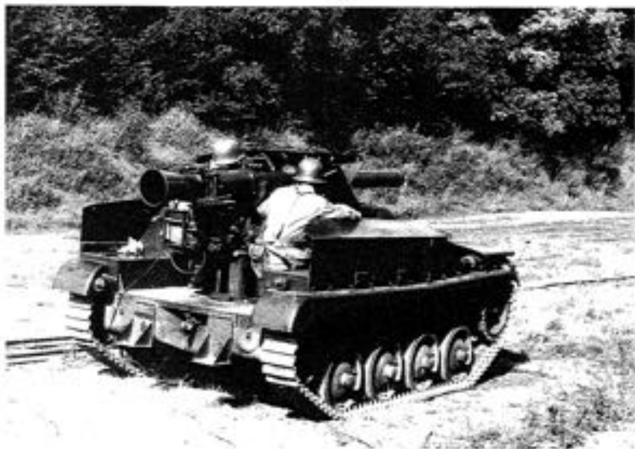
CANON DE 150 MM SANS RECOL MONTE SUR CHENILLETTE PENDANT LES ESSAIS DE TIR (DEBUT DES ANNEES 50).
