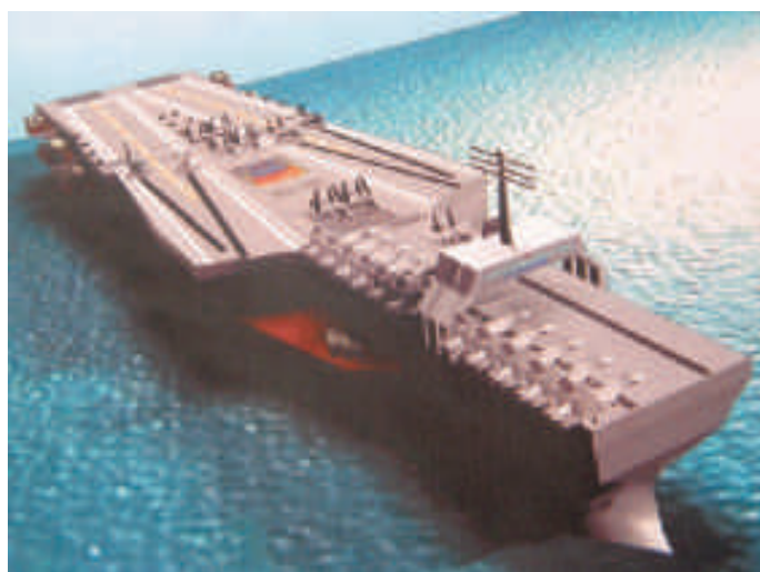
Impression d'artiste publiée en Chine et montrant un porte-avions original doté de deux pistes obliques avec un îlot sur l'avant.
