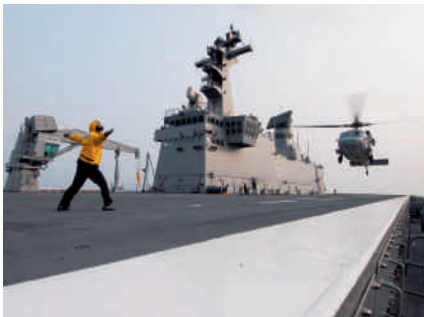
Le pont d'envol du Dokdo sud-coréen est renforcé pour supporter les jets d'un appareil à réaction.
