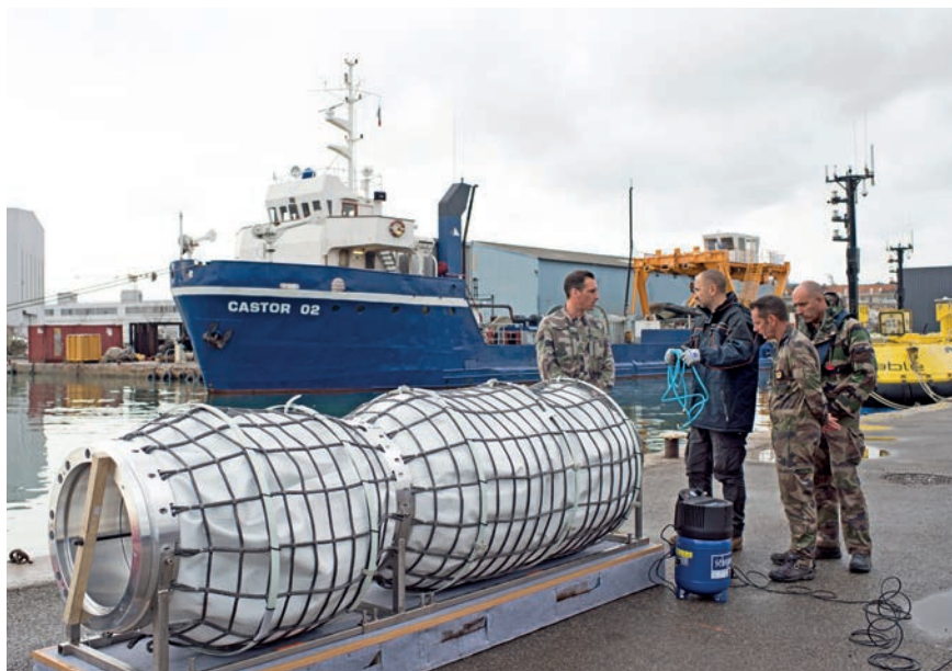
Présentation et premiers tests du caisson d'oxygénation hyperbare transportable Oracle le 9 janvier à Toulon.
