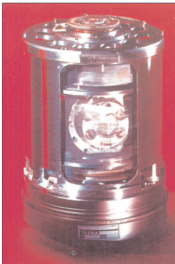
Bloc de guidage gyroskopique du missile Exocet (1970-2000). Le plateau a le diamètre du missile, soit 350 mm.
