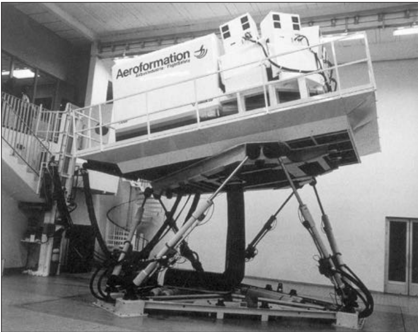
Simulateur d'entraînement pour avion de transport type 350 (Source GIFAS).
