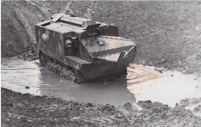
Char Schneider, équipé d'un canon de 75mm court en casemate et de 2 mitrailleuses Hotchkiss de 8mm
