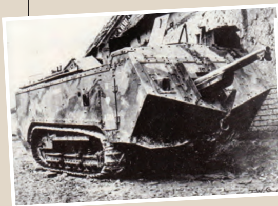
Char Saint-Chamond, équipé d'un canon de 75mm et de 4 mitrailleuses Hotchkiss de 8mm
