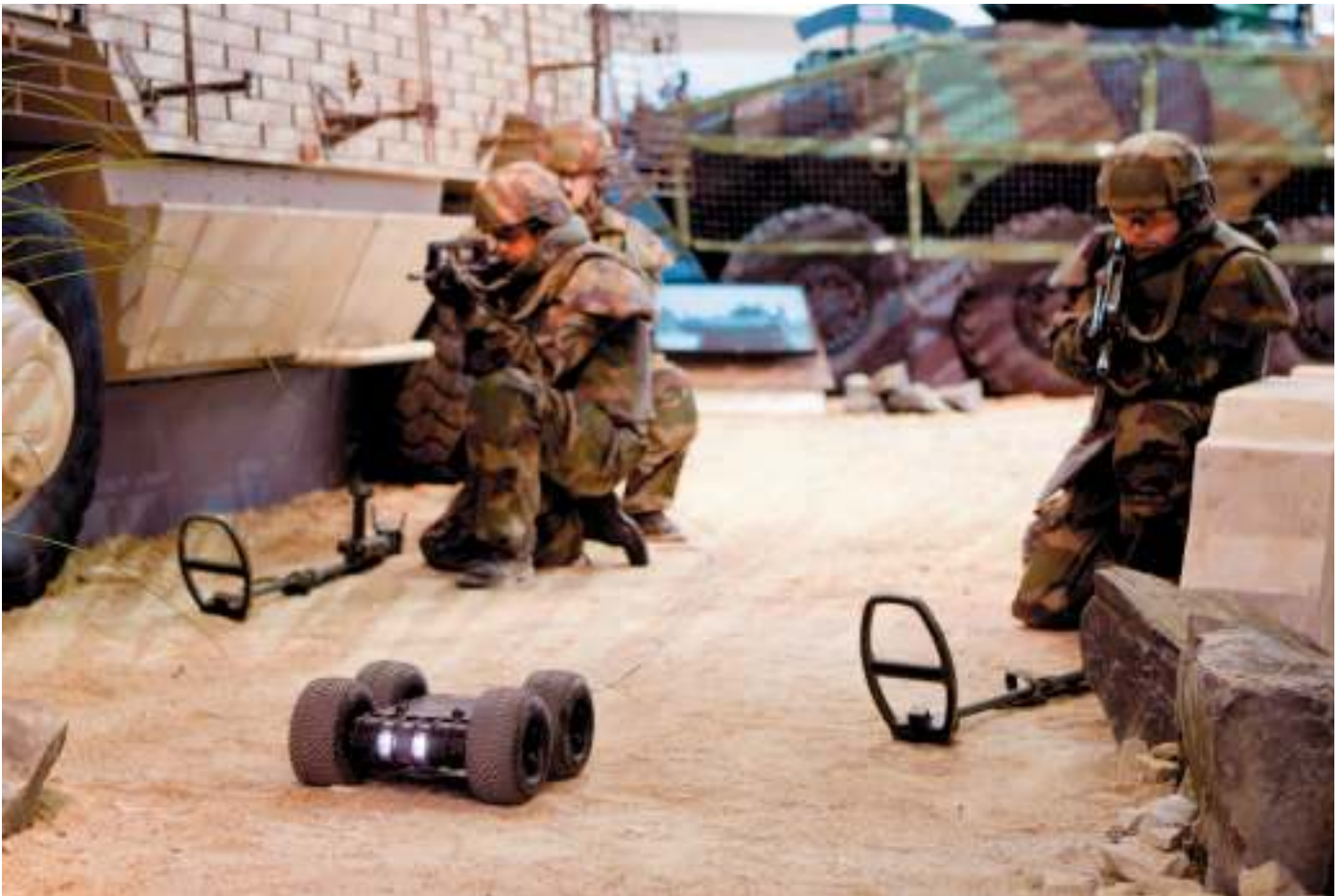
En haut : démonstration par un soldat de l'exosquelette Hercule, plasma lyophilisé, VBCI exposé dans sa version « félinisée ». Ci-dessus : des soldats équipés du système fantassin à équipements et liaisons intégrés (Félin) avec, au premier plan, un robot Minirogen destiné à identifier les engins explosifs grâce à sa caméra.
