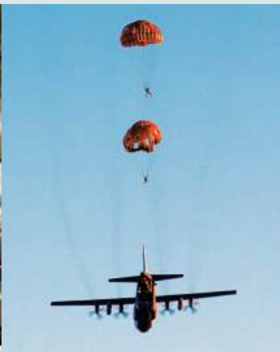
L'EPC offre la possibilité de descendre jusqu'à 85 mètres la hauteur de largage, en toute sécurité.
