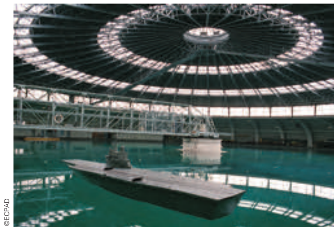
©ECPAD Une maquette du Charles-de-Gaulle dans le bassin d'essais des carènes.
