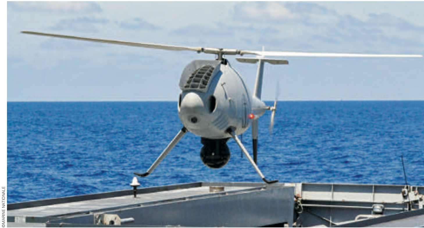
Essais en Méditerranée d'un drone hélicoptère Schiebel S-100 sur le patrouilleur hauturier L'Adroit.
