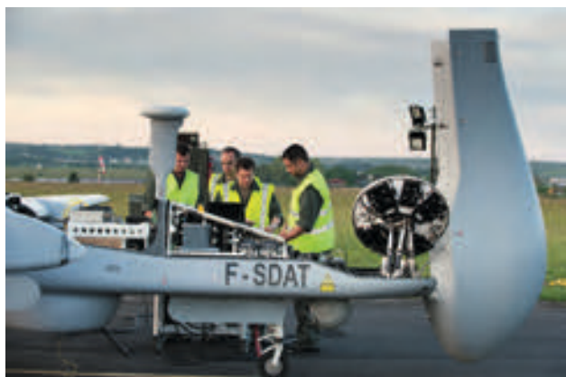
Vérification par ordinateur des systèmes du Harfang avant décollage.
