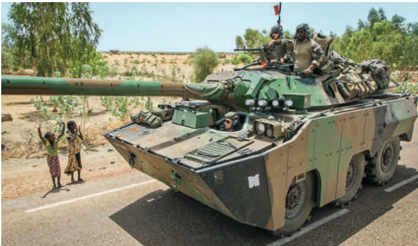
Le blindé léger AMX 10 RCR, engin de reconnaissance employé sur la plupart des théâtres, ici au Mali pendant l'opération Serval, sera remplacé dans le cadre du programme Scorpion par l'engin blindé de reconnaissance et de combat.
