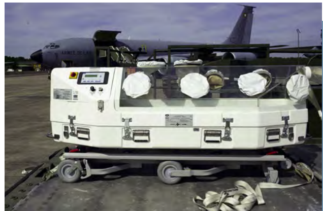
Caisson de transport en milieu protégé dont l'interface aérotransport a été réalisée par l'EEST.
