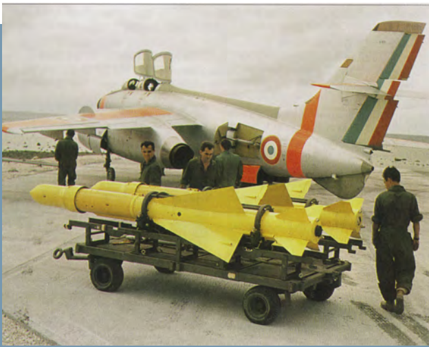
Un des Vautour du Loire avec ses missiles de prélèvement Matra.
