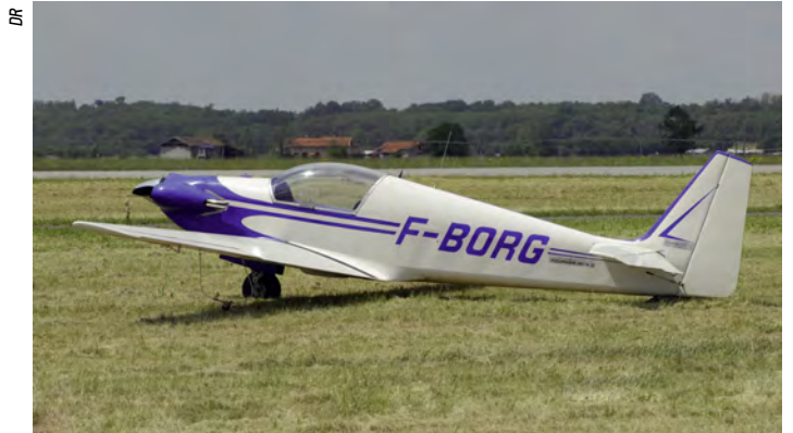
Le motoplaner Fournier RF-4 avec train monorace et balancines.
