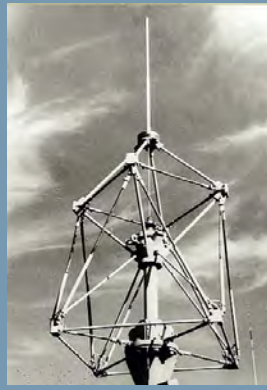
Une antenne pour bâtiments : nombre de barreaux ne servent qu'à rigidifier l'ensemble.
