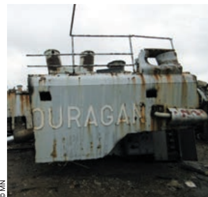
Dépose à quai d'un élément découpé issu de la coque de l'ex-Ouragan.
