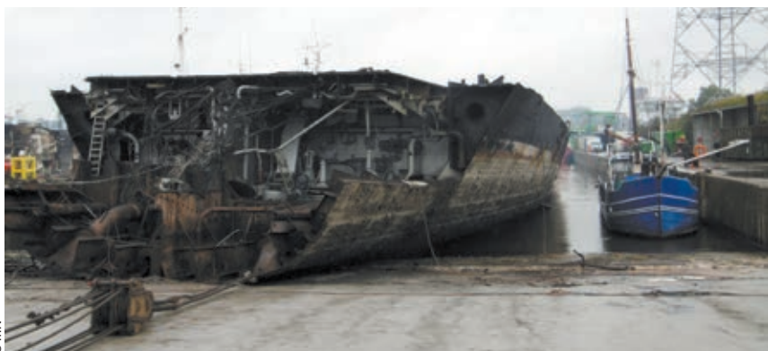
Semelle de la coque de l'ex-Ouragan en attente de traction au sec au chantier de déconstruction à Gand (Belgique).
