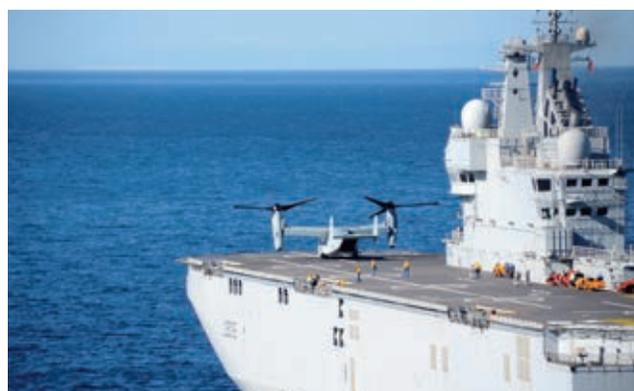
BPC, le spot d'appontage numéro 1, situé à l'avant du pont d'envol, est renforcé pour les hélicoptères lourds. Cependant, si les BPC ont l'habitude d'accueillir des hélicoptères *Caiman* pouvant peser jusqu'à 10 tonnes en pleine charge, le V22 qui s'est posé pesait 22 tonnes, soit plus du double. Dans l'appareil, les pilotes d'essai, le
