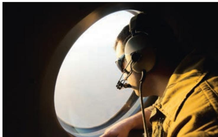
Un observateur scrute à travers un sabord. Ces ouvertures sur les côtés permettent une vision à 360° de l'appareil.
