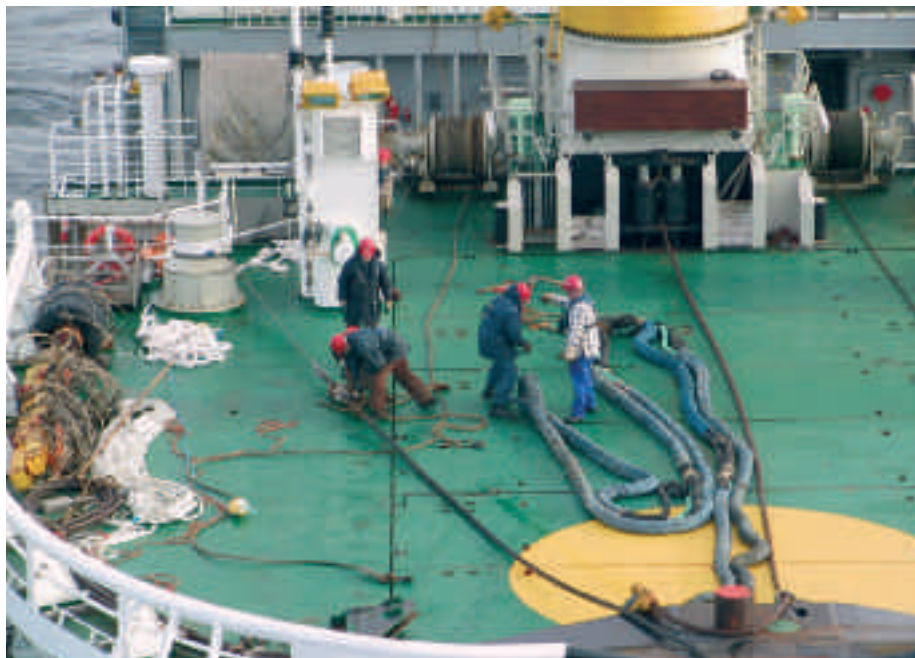
Figure 15 : le hâle (bleu) et l'aussière (blanche) sur le pont du Neuwerk (Neuwerk, exercice de remorquage d'urgence avec le Betty Knutsen, 13/04/2007).
