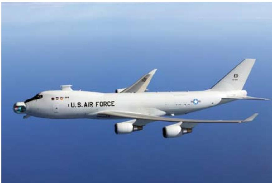
*Boeing YAL-1 Airborne Laser (ABL), également appelé YAL-1A, est une arme embarquée (airborne) basée sur un laser délivrant une puissance de l'ordre du megawatt et de type chimique iode-oxygène (en anglais, *Chemical Oxygen Iodine Laser* : COIL) développé pour l'US Air Force. Son objectif est la destruction de missiles en vol.*
